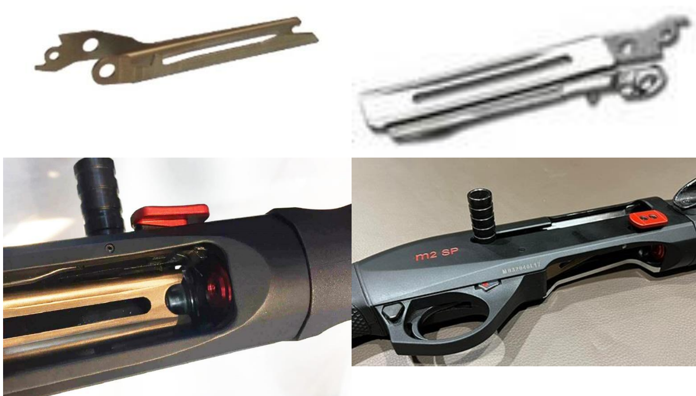
Figura 9 – Exemplos de modificações/ acessórios na rampa de carregamento permitidas na Divisão Semiautomática e Repetição
